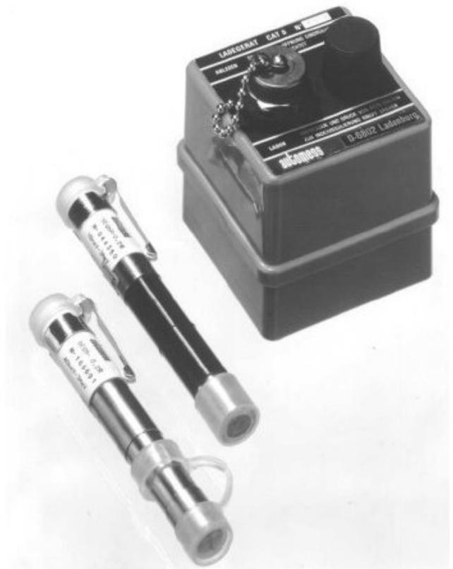
Füllhalterdosimeter mit Ladegerät, Empfindlichkeit je nach Typ von 18 keV bis 3 MeV; Anzeigebereiche 1 mSv bis 2 Sv (SEQ5 und SEQ6R, automess)
