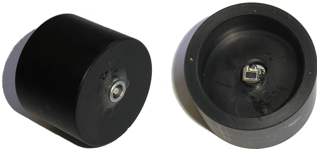
(a) Halterung für die Triggerdiode aus Acetal zum Aufstecken samt Lemo-Buchse für die Auslese
