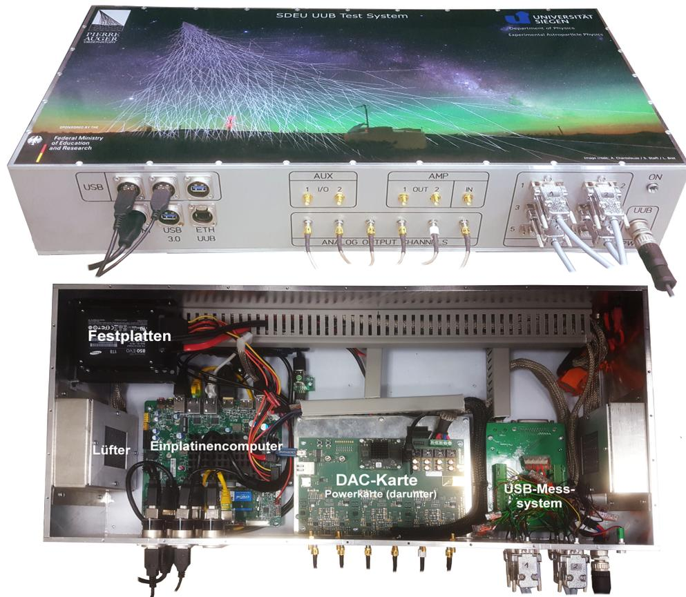
Abbildung 4.3.: Außen- und Innenansicht des Testsystems. Aus Platzgründen wurde die DAC-Karte eine Ebene über der Powerkarte angebracht.
