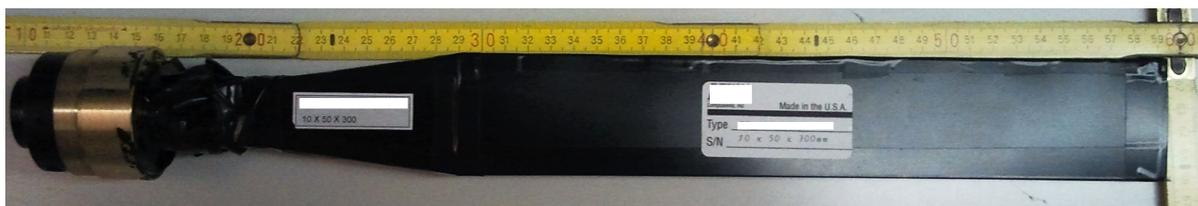
Abb. 10: Szintillator des PMT2. Dieser war bei Übernahme bereits in schwarzes, lichtundurchlässiges Material eingepackt. Aufgeklebt sind zwei Notizen zur Größe ( $10\text{ mm} \times 50\text{ mm} \times 300\text{ mm}$ ) und Material [MSZ] der aktiven Fläche. Das aktive Material wird mit Hilfe mehrerer Stücke nicht adiabatischen Lichtleiters mit dem PMT verbunden.
