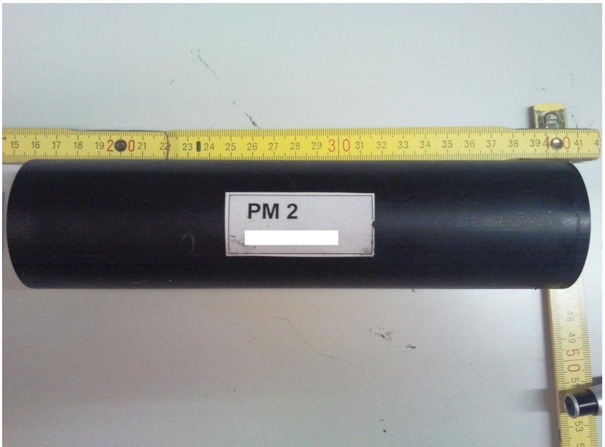
Abb. 30: Äußere Metallröhre, in die der PMT eingesetzt wird.
