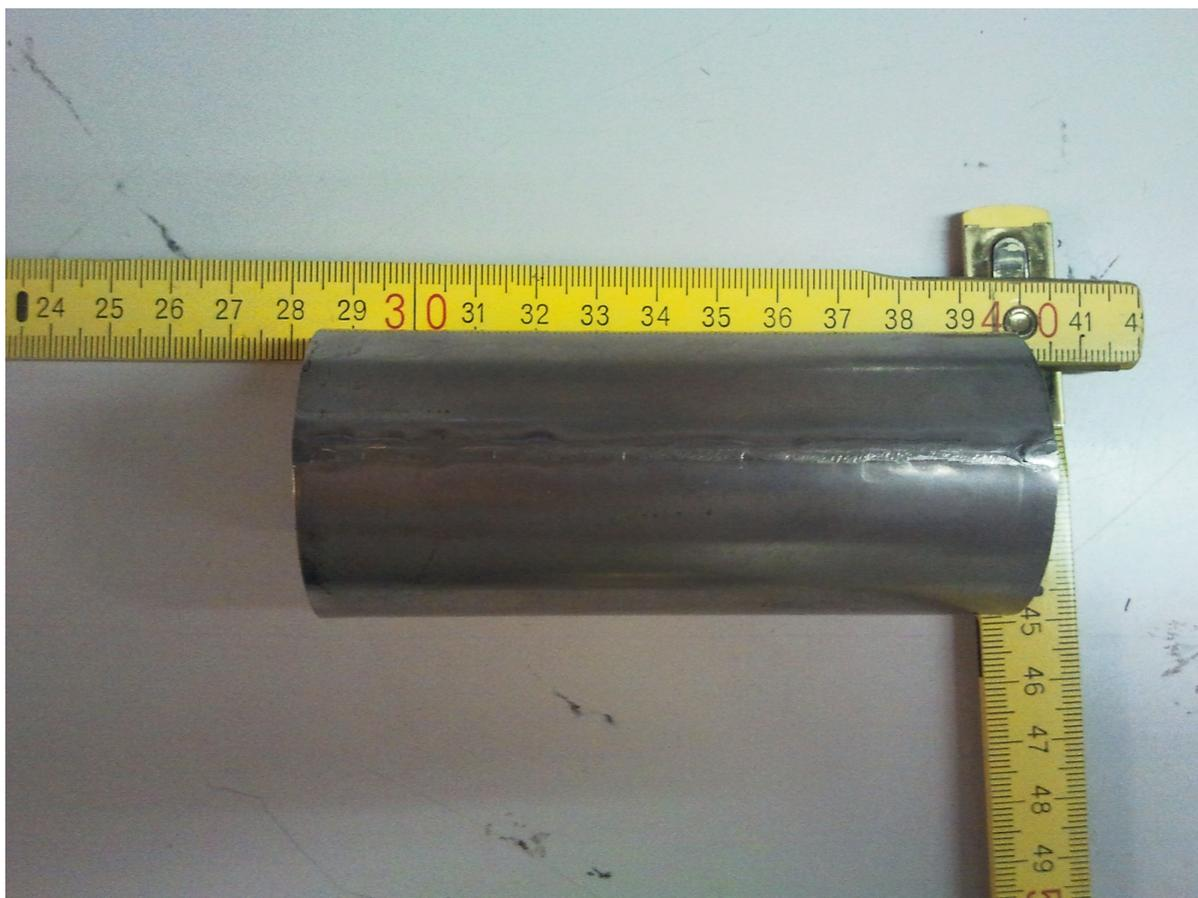
Abb. 31: Mu-Metallröhre, die zwischen PMT und die äußere Metallröhre geschoben wird.
