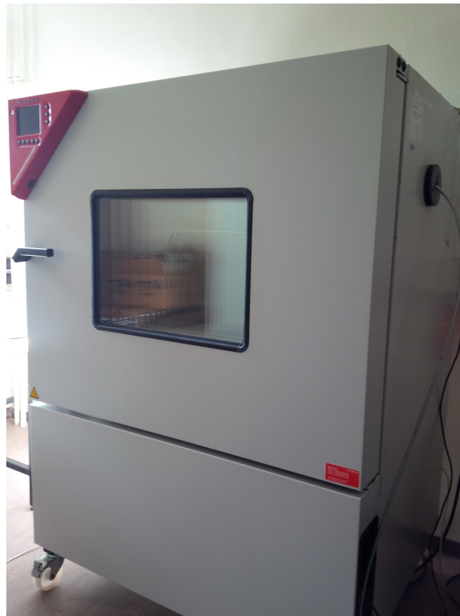
Abbildung 5.1.: Klimaprüfschrank in einem Labor der experimentellen Teilchenphysik der Universität Siegen.
