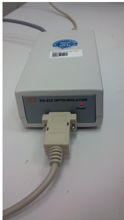
Abbildung 5.2.: Optokoppler: Die hellen Kabel vorne und hinten sind über serielle Schnittstellen des Typs RS 232 mit dem PC und dem Adapter verbunden. Das graue Kabel hinten links bildet die Stromversorgung des Optokopplers.
