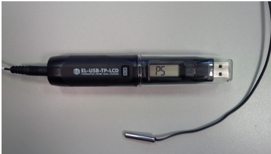
Abbildung 5.4.: Temperatursensor: Über einen USB-Anschluss können die Messwerte des Sensors (Mitte unten) am PC ausgelesen werden.
