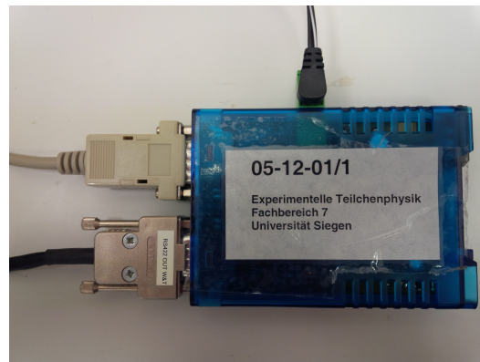
Abbildung 5.3.: Der Adapter von RS 232 auf RS 422 ermöglicht es, Klimaprüfschrank und PC miteinander zu verbinden. Auf der linken Seite befinden sich oben die Schnittstelle RS 232 für den PC und unten die Schnittstelle RS 422 für den Klimaprüfschrank. Der schwarze Stecker oben bildet die Stromversorgung für den Adapter.
