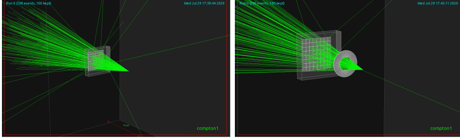
Abbildung 3.4: Simulation der Startimpulsverteilung durch die Bleiblende: Links die Photontracks (grün), welche durch die simulierte Blende einen Kegel formen, bis sie auf den Detektor treffen. Rechts daneben ist zur Veranschaulichung die Bleiblende dargestellt. Es ist zu erkennen, dass alle Photonen durch diese Blende fliegen. Es wurden 200 Gammas der Energie 511 keV simuliert.
