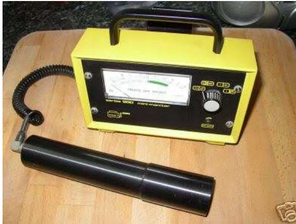
Fig. 0.50. Ein handlicher Geigerzähler zur Messung von Beta- und Gammastrahlen
