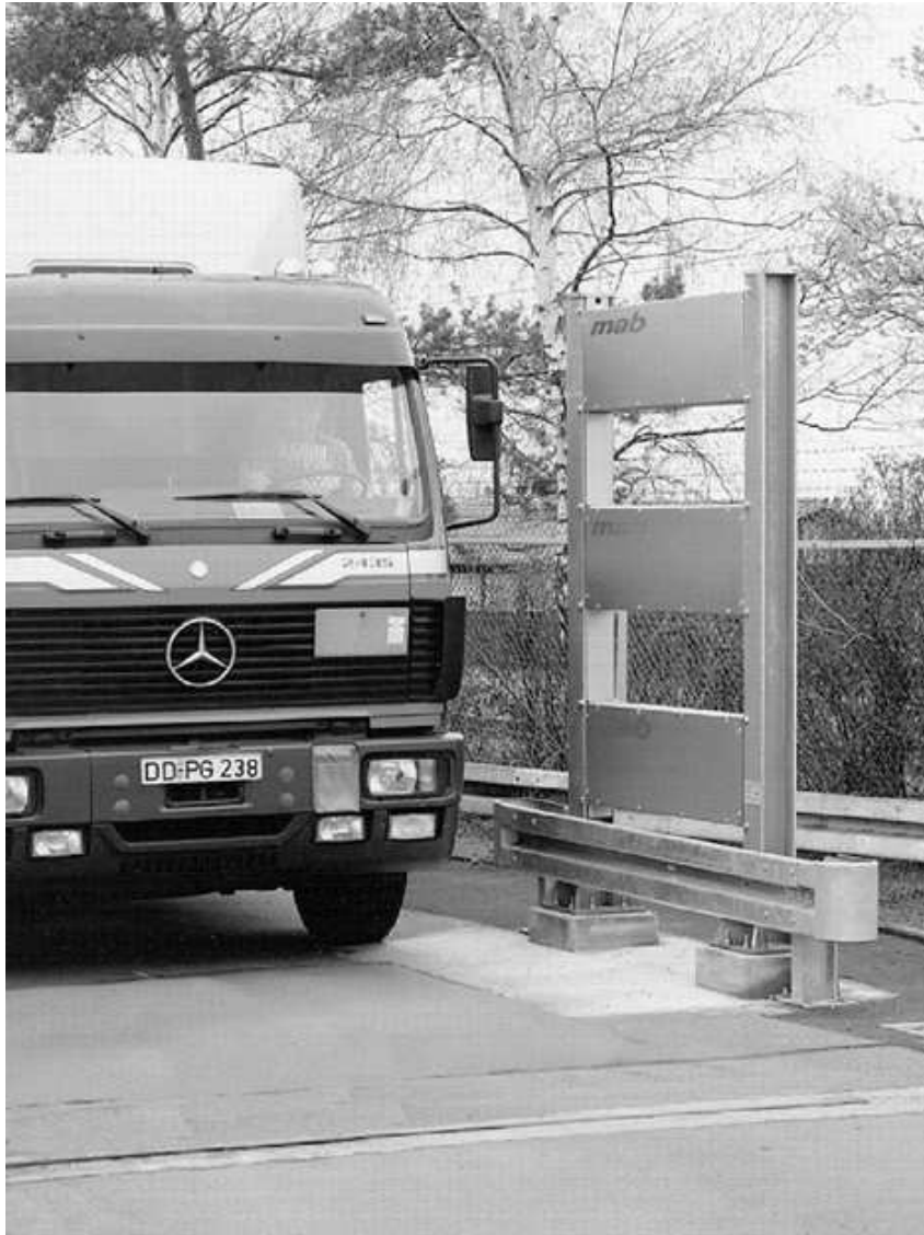
Stationäre Radioaktivitätsmessanlage zur Kontrolle von LKW's, ausgerüstet mit Plastik-Szintillationszählern (Typ FZM 700, Münchner Apparatebau)
