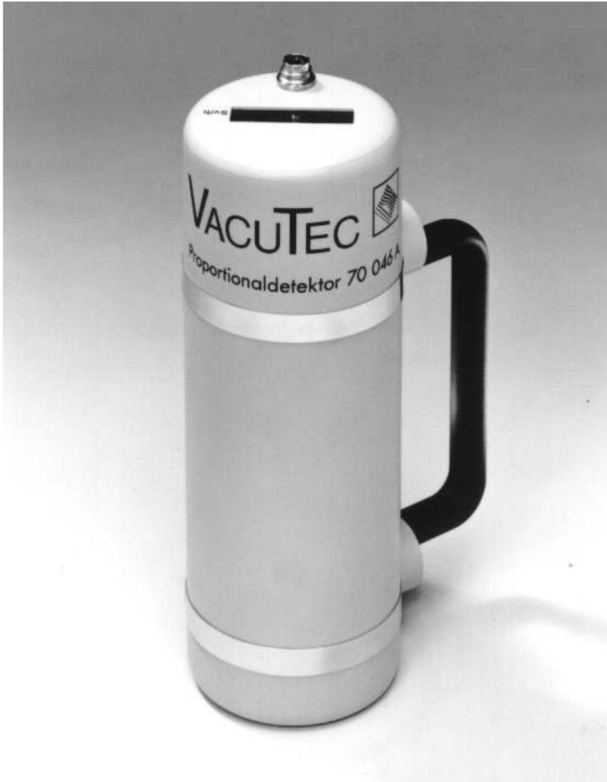
Umgebungsüberwachung mit einem tragbaren Proportionalkammerdetektor; Messbereich 5 nSv/h bis > 1 Sv/h (VacuTec-Messtechnik GmbH)
