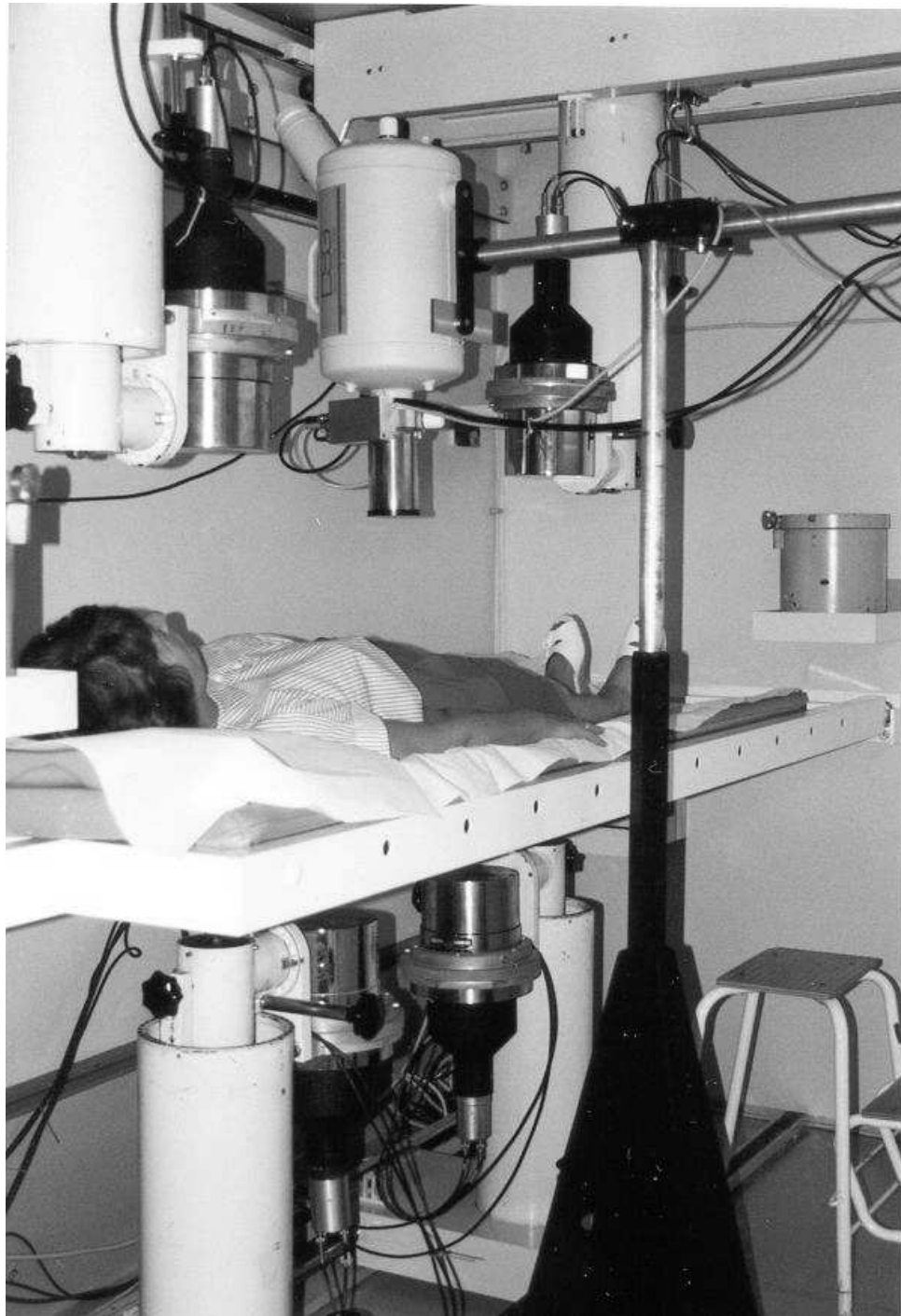
Ganzkörperzähler mit NaI(Tl)-Detektoren ( www.strz.uni-giessen.de/gkz.htm )
