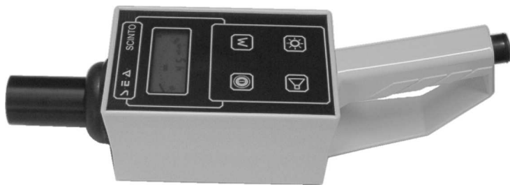
Dosisleistungsmessgerät mit NaI-Detektor; Dosisleistungsmessbereich 40 nSv/h–2 mSv/h (Typ SCINTO, S.E.A. GmbH)
