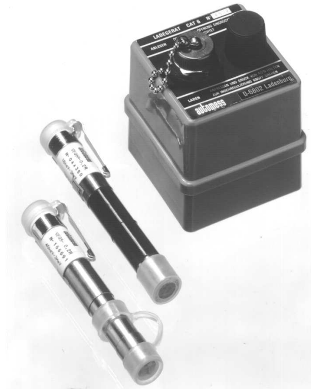
Füllhalterdosimeter mit Ladegerät, Empfindlichkeit je nach Typ von 18 keV bis 3 MeV; Anzeigebereiche 1 mSv bis 2 Sv (SEQ5 und SEQ6R, automess)
