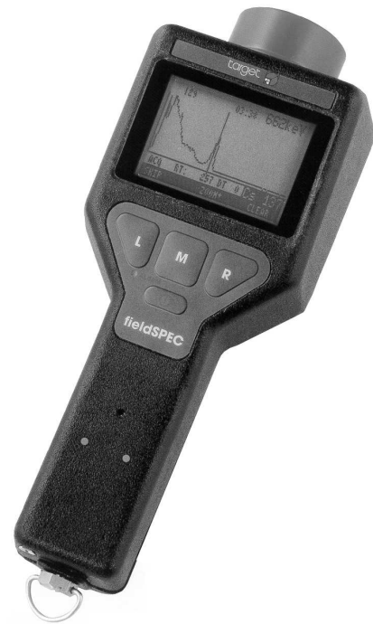
Digitales tragbares Gammaskpektrometer mit NaI-Szintillationsdetektor zur Dosisleistungsmessung und Nuklididentifikation. Messbereich 10 nSv/h–1 Sv/h, 20 keV–2,5 MeV (Typ fieldSPEC, target systemelectronic GmbH)
