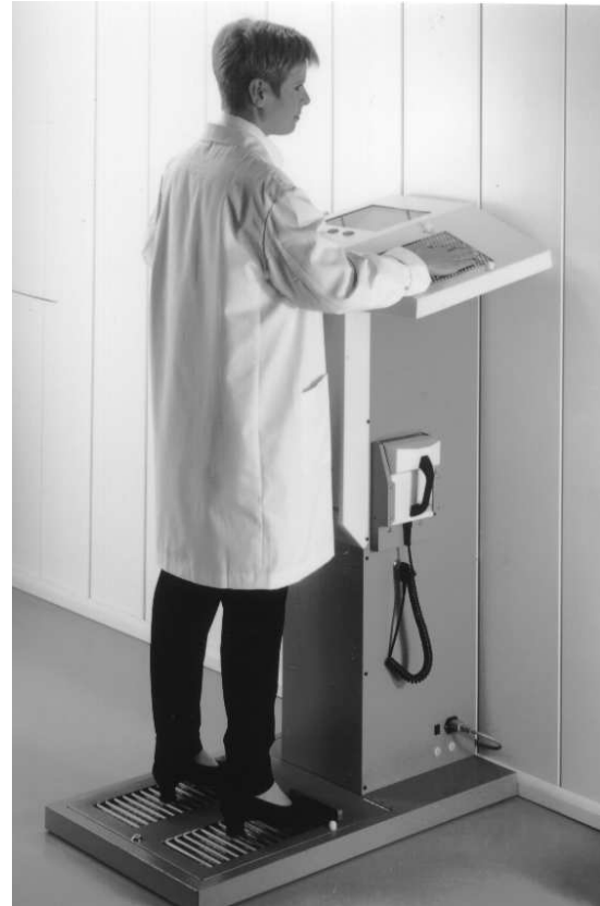
Hand-Fuß-Monitor zur Messung von \beta - oder \alpha - und \beta -Strahlen mit Großflächenzählern (Modell LB 145, EG&G Berthold)
