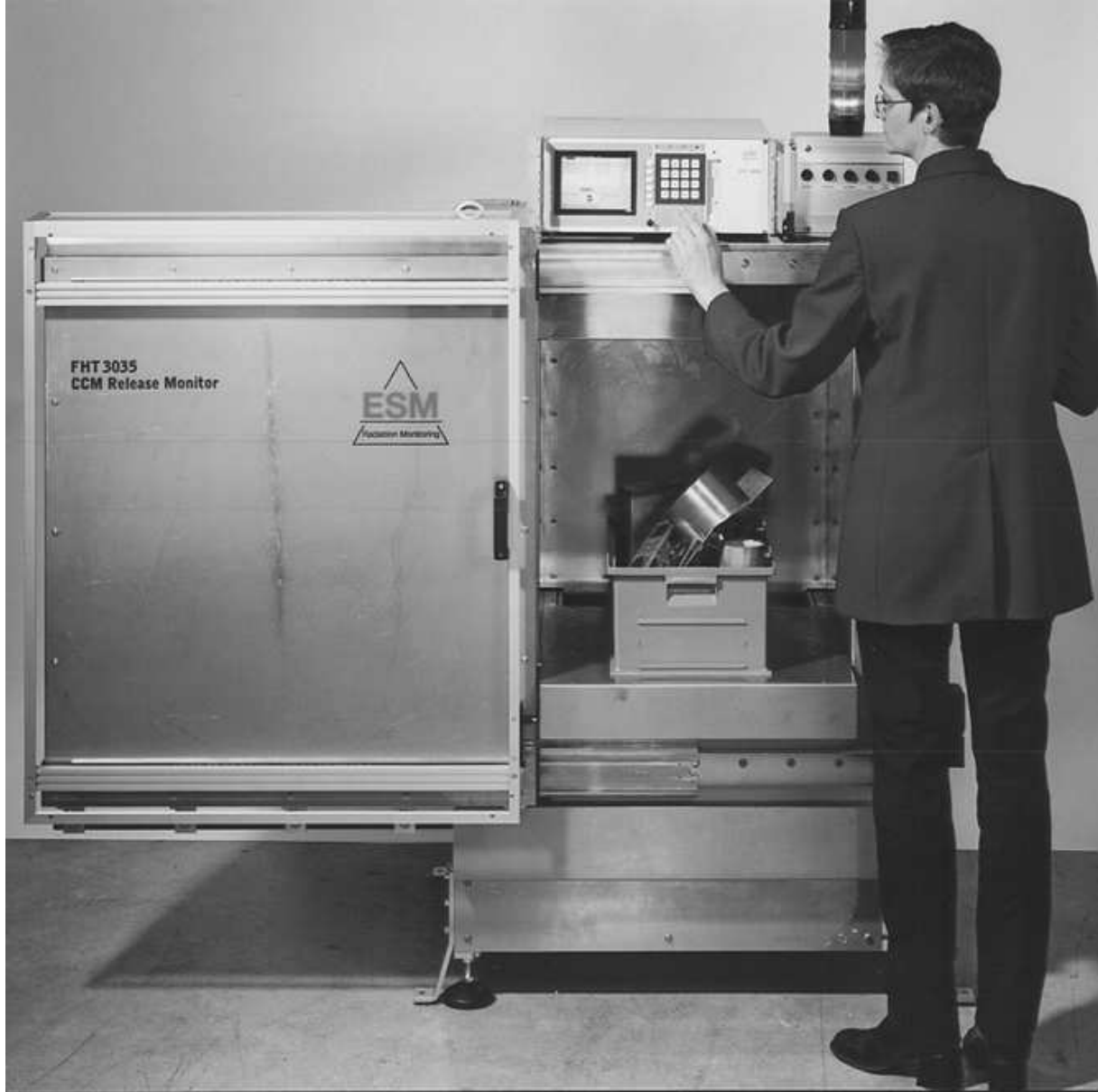
Freigabemonitor zur Ausmessung der spezifischen Aktivität von Werkzeugen und Maschinenteilen (Typ CCM Freigabemonitor FHT 3035, Thermo Eberline ESM)
