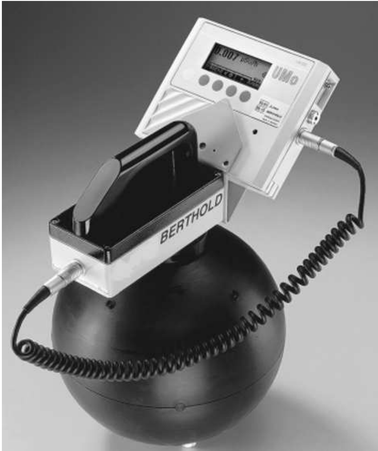
Neutronendosisleistungs-Messgerät mit Polyethylen-Moderator; Zählgas: ^3\text{Helium} /Methan; Anzeige in \mu\text{Sv/h} (Modell LB 6410; Berthold Technologies)
