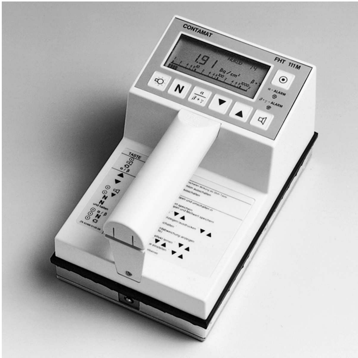
Kontaminationsmonitor als Großflächenzähler für \alpha -, \beta - und \gamma -Strahlung; Anzeige in s^{-1} oder in Bq/cm^2 (Typ Contamat FHT 111 M, ESM Eberline Instruments GmbH)
