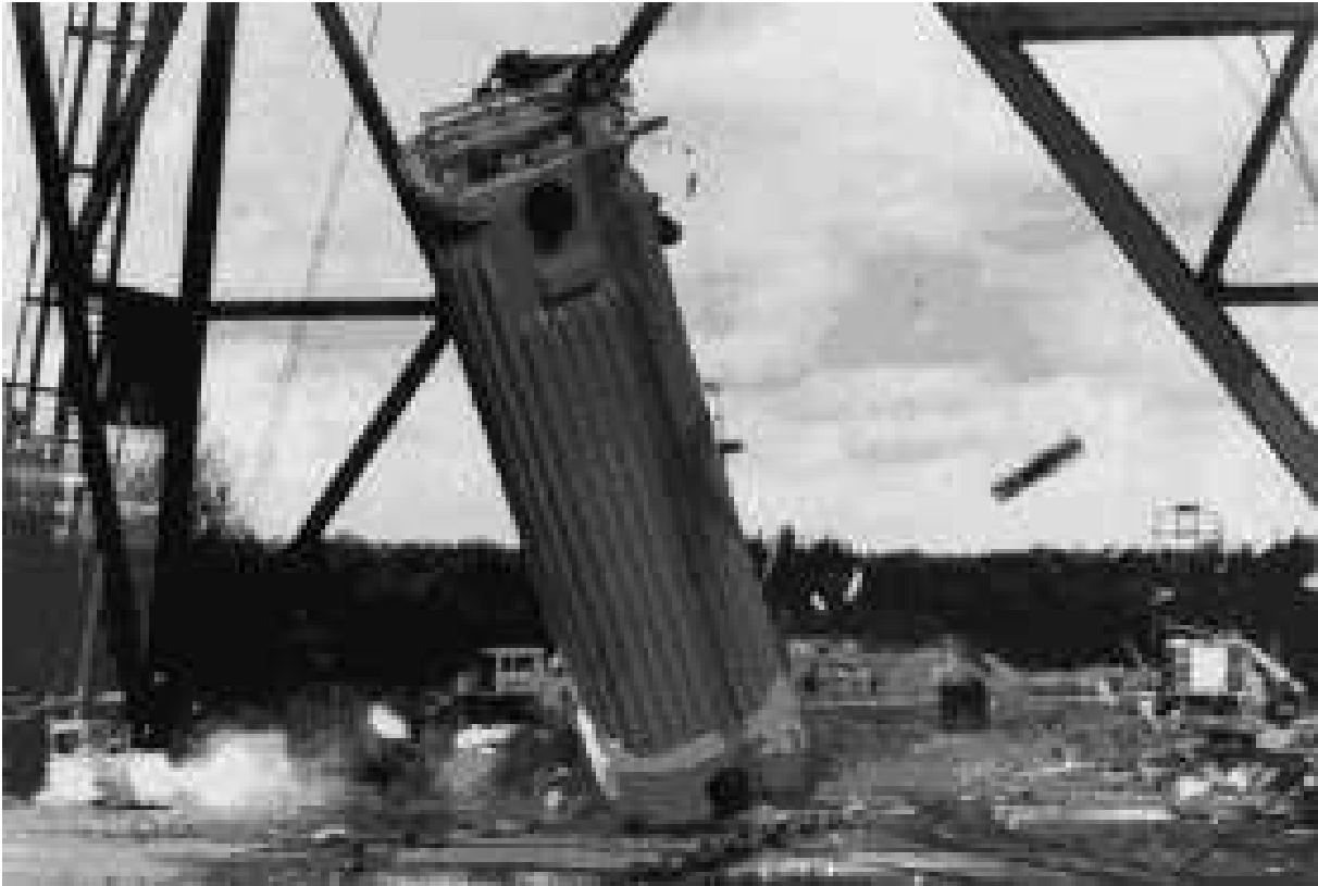
Fallversuch mit einem CASTOR-Behälter ( http://www.gns-nuklearservice.de )
