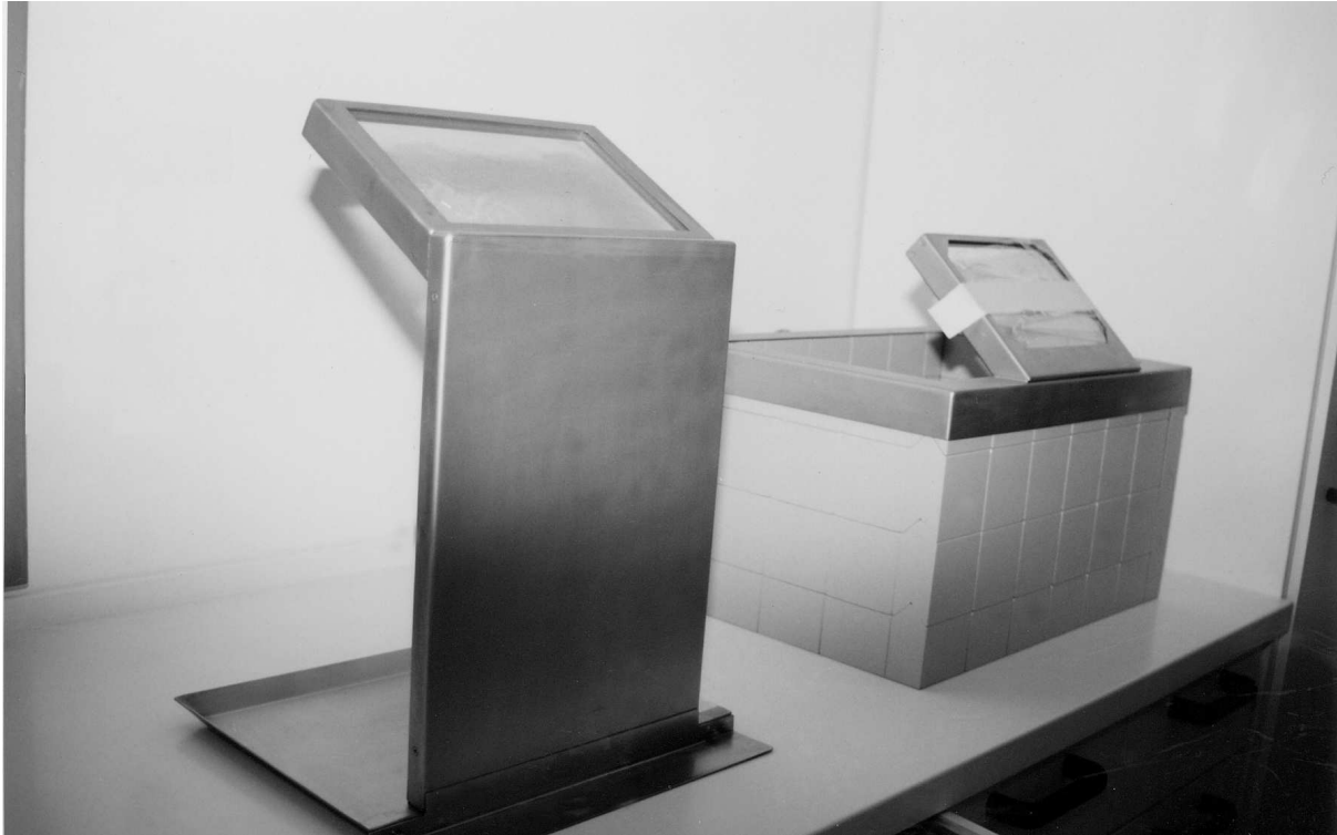
Arbeitsplatzausrüstung: Strahlenschutz-Brustwehr mit Bleiglasfenster und Bleiburg mit Bleiglasfenster (JL Goslar GmbH)
