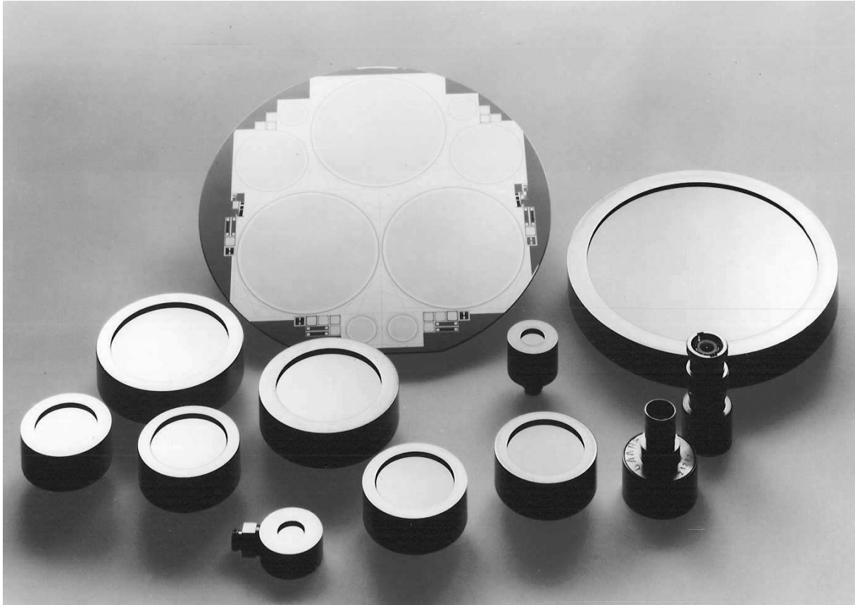
Ionenimplantierte Silizium-Detektoren, PIPS (Passivated Implanted Planar Silicon Detectors), zur Messung von \alpha -Teilchen (CANBERRA EURISYS GmbH)
