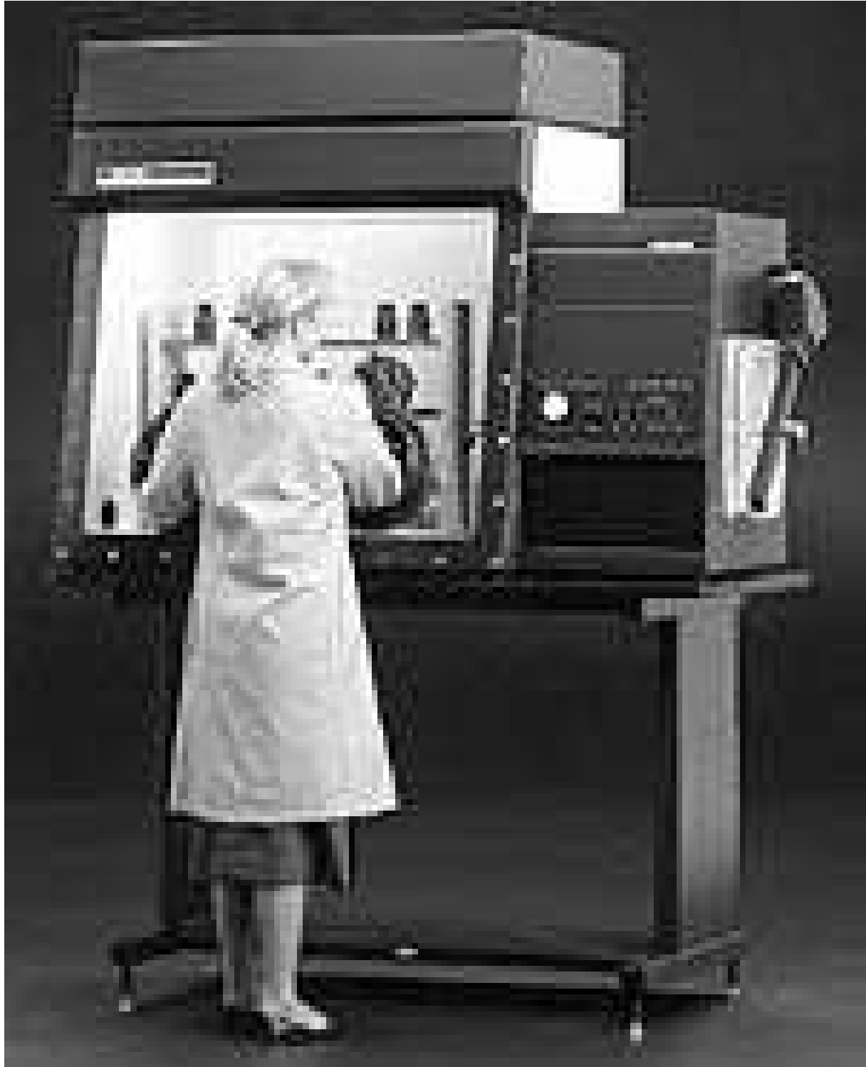
Handschuhbox zum sicheren Arbeiten mit radioaktiven Stoffen (Labconco Corporation)
