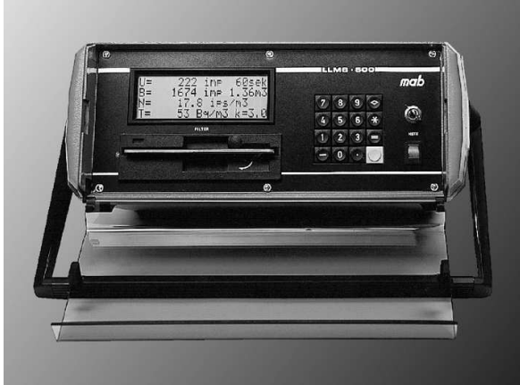
Low-Level-Monitor-System mit Staubprobensammler zur Messung geringer Beta-Aktivitäten, z. B. im Rahmen von Radon-Filter-Messungen (Modell LLM 500, Münchener Apparatebau)
