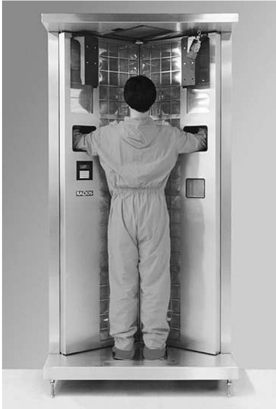
Ganzkörper-Kontaminationsmonitor zur Messung von \alpha -, \beta - und \gamma -Kontaminationen mit einem System von Großflächenzählern (Typ RADOS RTM860TS, RADOS TECHNOLOGY GmbH)
